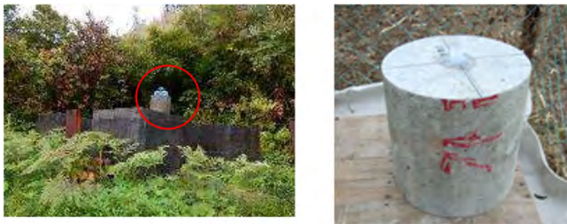
Fig. 7 Specimen for temperature measurement Échantillon pour la mesure de la température
