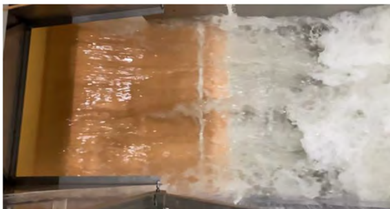
Fig. 5 Model tests in energy dissipation rig at 240 l/s Essais sur modèle de dissipation d'énergie avec 240 l/s
