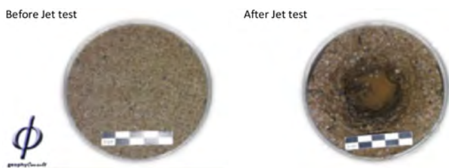
Fig. 4 Example of soil sample in a Proctor mold before and after Jet test Exemple d'échantillon de sol dans un moule Proctor avant et après essai Jet
