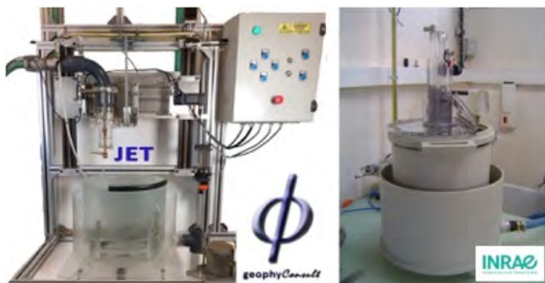
Fig. 3 View of the JET devices at the laboratory Vue des dispositifs JET au laboratoire
