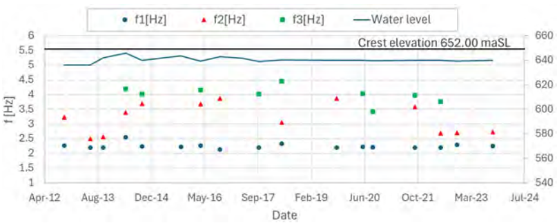
Fig. 3 First 3 frequencies (Hz) recorded and water elevation during measuring campaigns for Block 9 Les trois premières fréquences (Hz) enregistrées et le niveau de l'eau lors des campagnes de mesure pour le bloc 9
